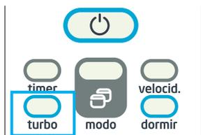
Para desativar a função Turbo, pressione novamente o botão da função. O aparelho voltará para última configuração programada.
