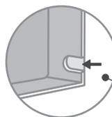
Se a tomada/disjuntor estiver instalado no lado esquerdo do aparelho, essa área da frente plástica deve ser quebrada para a passagem do cabo.
