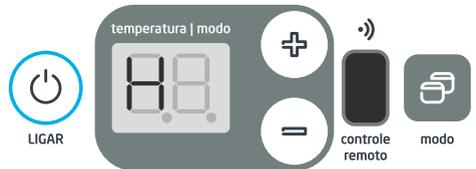
Ao pressionar o botão três vezes, o modo VENTILAÇÃO é ativado e a letra **F** é exibida no display do painel.
